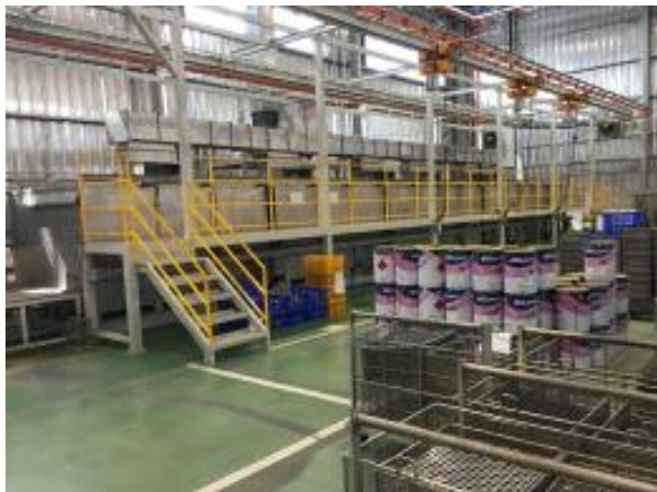
写真 3.2.3 化成皮膜処理設備
