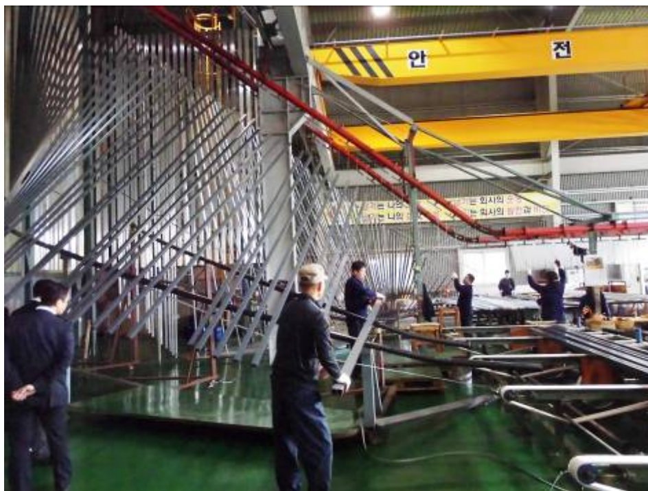
写真 3.1.5 粉体塗装後の吊り降し
