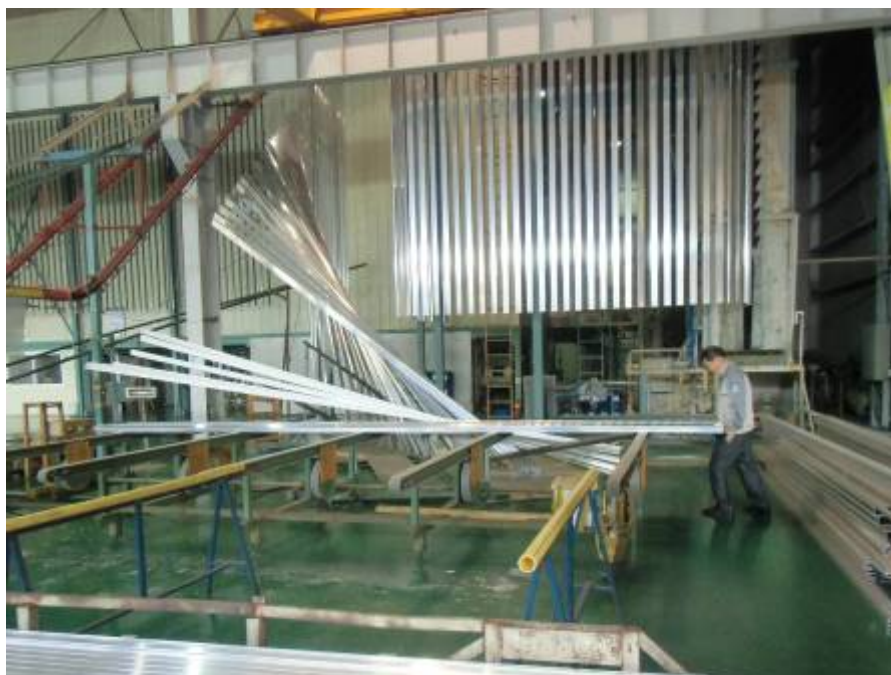
写真 3.1.1 縦吊り塗装設備
