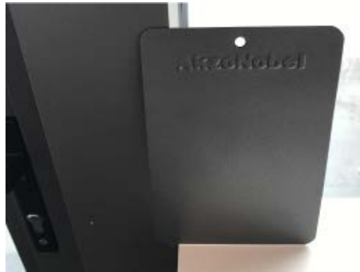
写真 3.6.6 色調見本板との確認（内部）
